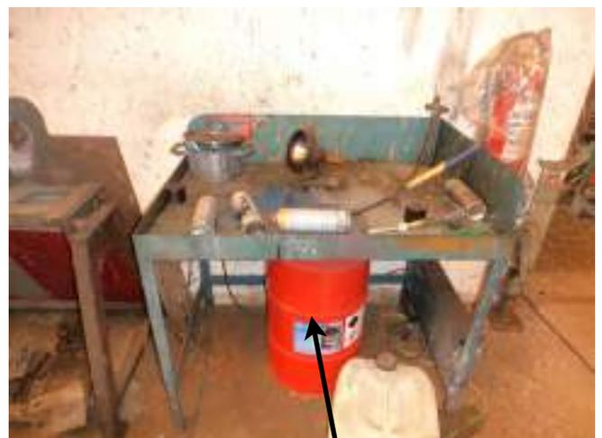
Foto 16: Geschlossener Teilereiniger in der Werkstatt mit Werkstattgrube.
